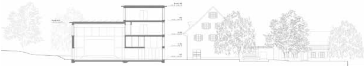
Abb. 18: Querschnitt Saalbau, Ansicht Südost Obere Mühle o.M.
