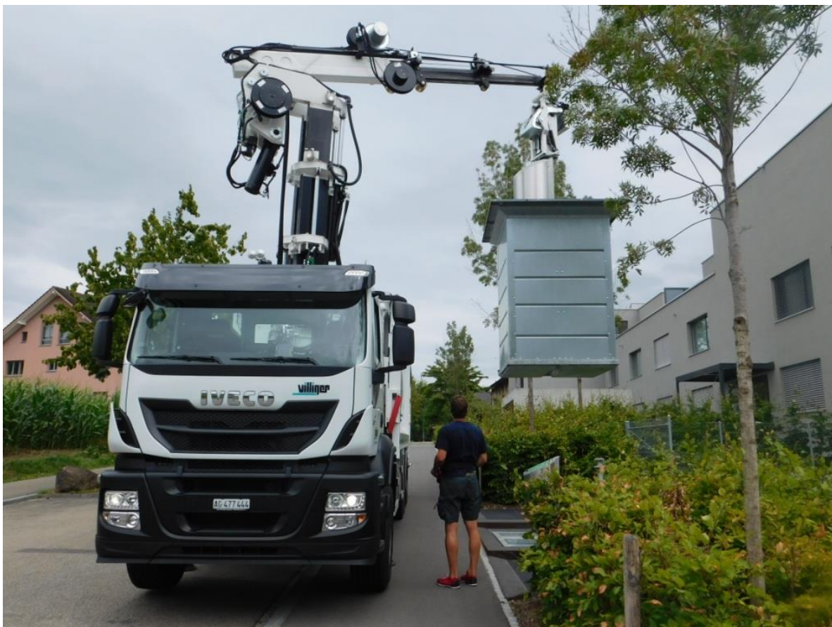
Unterflurcontainer bei der Entleerung
