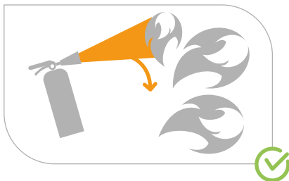
Abb. 29: Tropf- und Fließbrände von oben nach unten löschen
