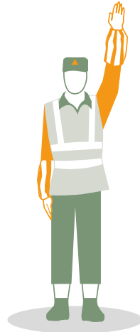
Abb. 38: Halt für alle Richtungen Hochhalten eines Armes.
