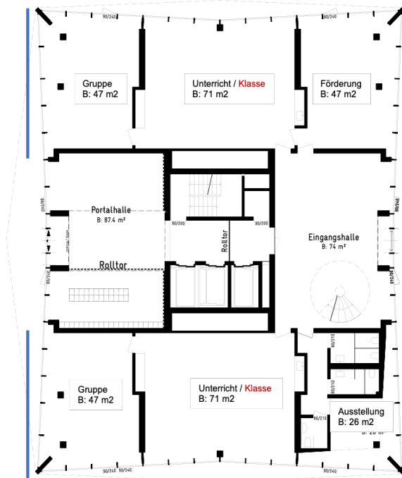
Erdgeschoss, Raumhöhe: 4.5m (OKFB - UKD)
