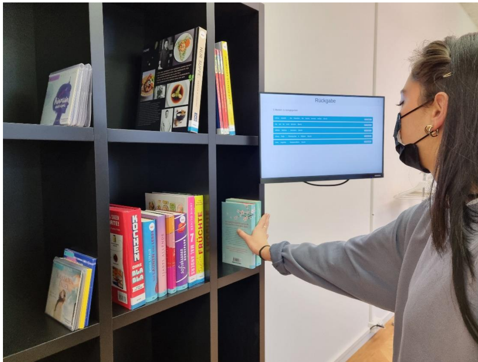
"Smart Shelf", das "intelligente Rückgaberegal": Die Medien werden einfach in die Fächer gestellt und sofort automatisch zurückgebucht.
