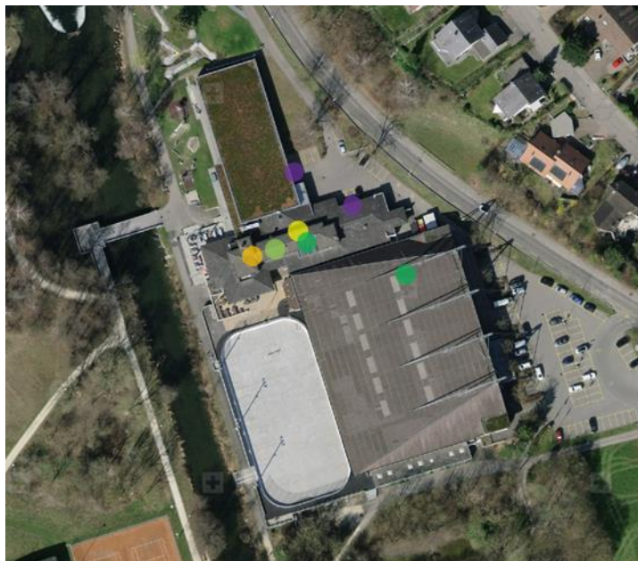
Abbildung 4: Übersicht Standort Wechselrichter («WR»), Hauptverteilung («HV»), Hausanschluss («HAK») und Einspeisung.
