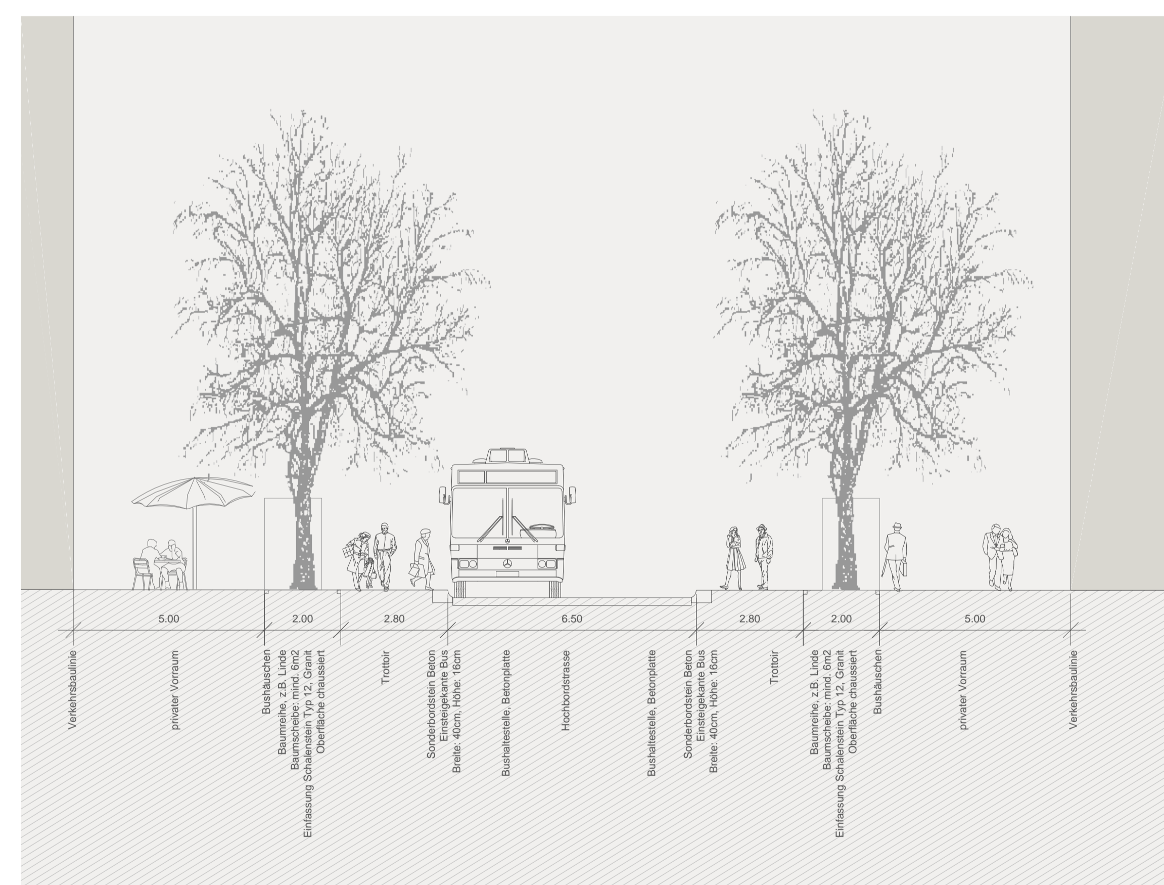
Hochbordstrasse A-A im Bereich der Bushaltestelle, M1:100
