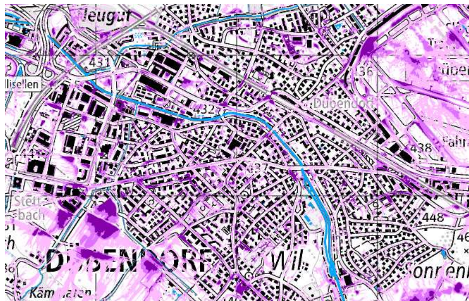
Abbildung 6: Gefährdungskarte Oberflächenabfluss und Überschwemmung 100 (Quelle: map.geo.admin.ch)
